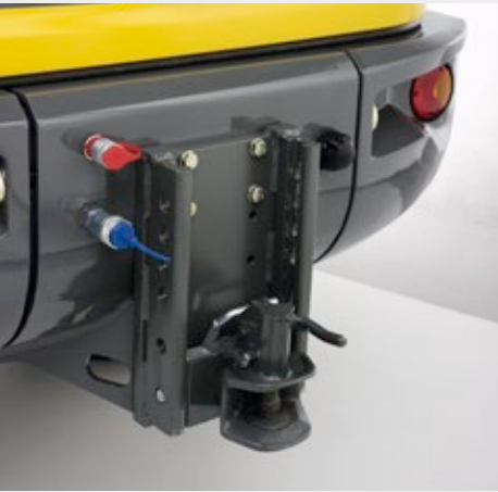
Optimální pro nejrůznější využití: Výšku závěsného zařízení přívěsu lze přizpůsobit flexibilně.
