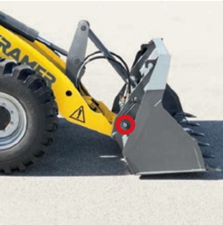
Hydraulická výměna zařízení - rychloupínací systémy Kramer: Dojedťte k přídatnému zařízení, přídatné zařízení hydraulicky uchopte z místa řidiče a zajistěte posuvným tlačítkem na joysticku. Blokovací válec je umístěn mimo bod otáčení rychloupínací desky, a není proto ve znečištěné oblasti.
