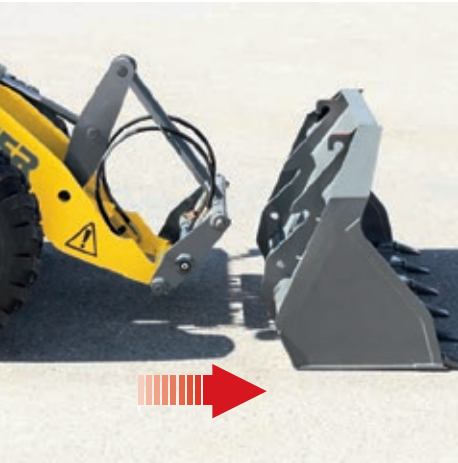
Hydraulická výměna zařízení - rychloupínací systémy Kramer: Dojedťte k přídatnému zařízení, přídatné zařízení hydraulicky uchopte z místa řidiče a zajistěte posuvným tlačítkem na joysticku. Blokovací válec je umístěn mimo bod otáčení rychloupínací desky, a není proto ve znečištěné oblasti.
