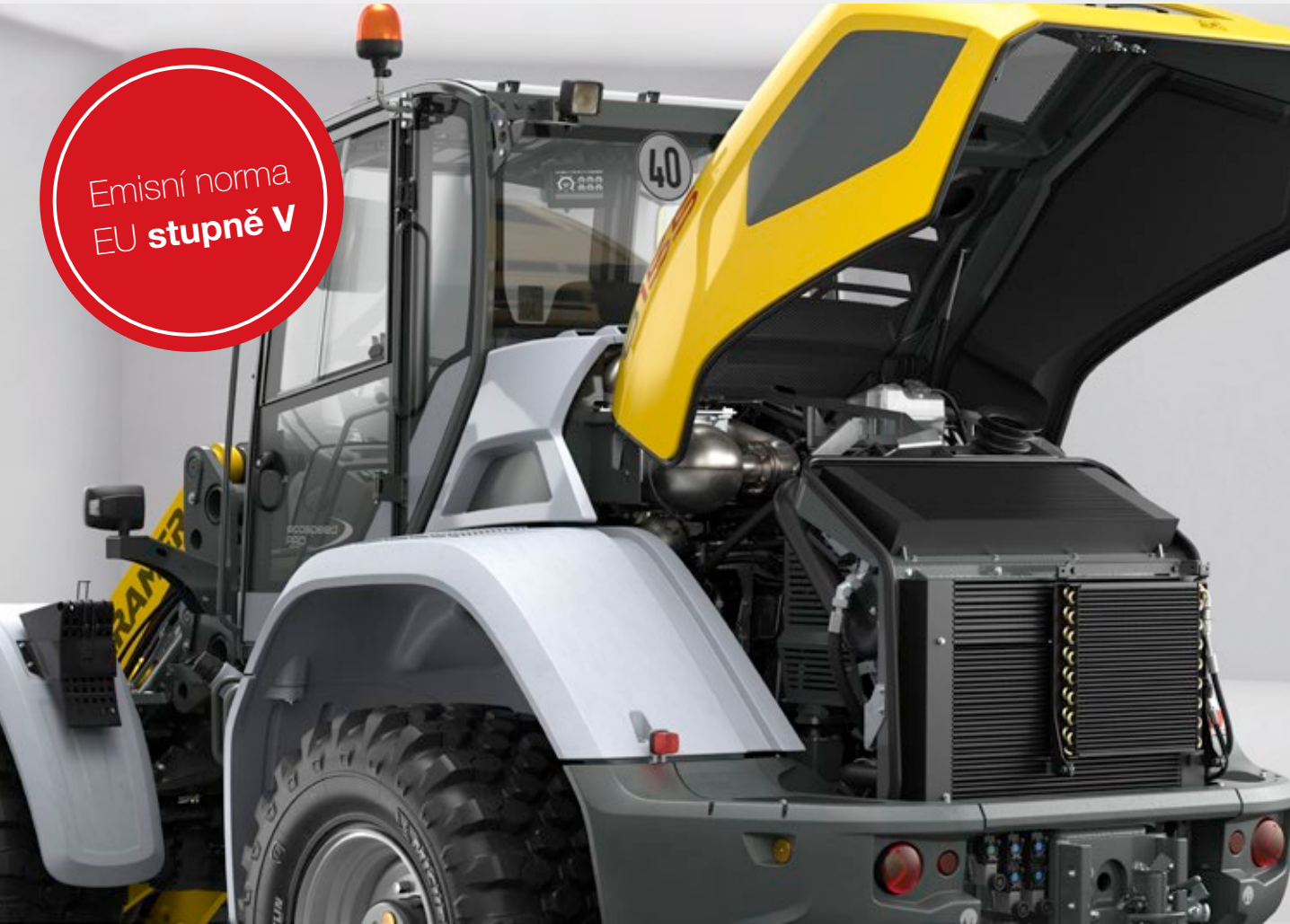
Vodou chlazený čtyřválcový řadový motor s chlazenou vnější recirkulací výfukových plynů, přeplňováním a chlazením plnicího vzduchu.
