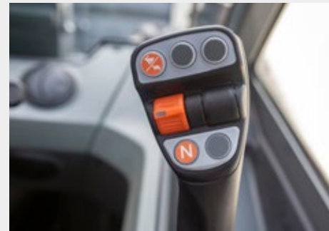
Pohodlný joystick: Možnost přepínání mezi zajícem a želvou na samotném joysticku.
